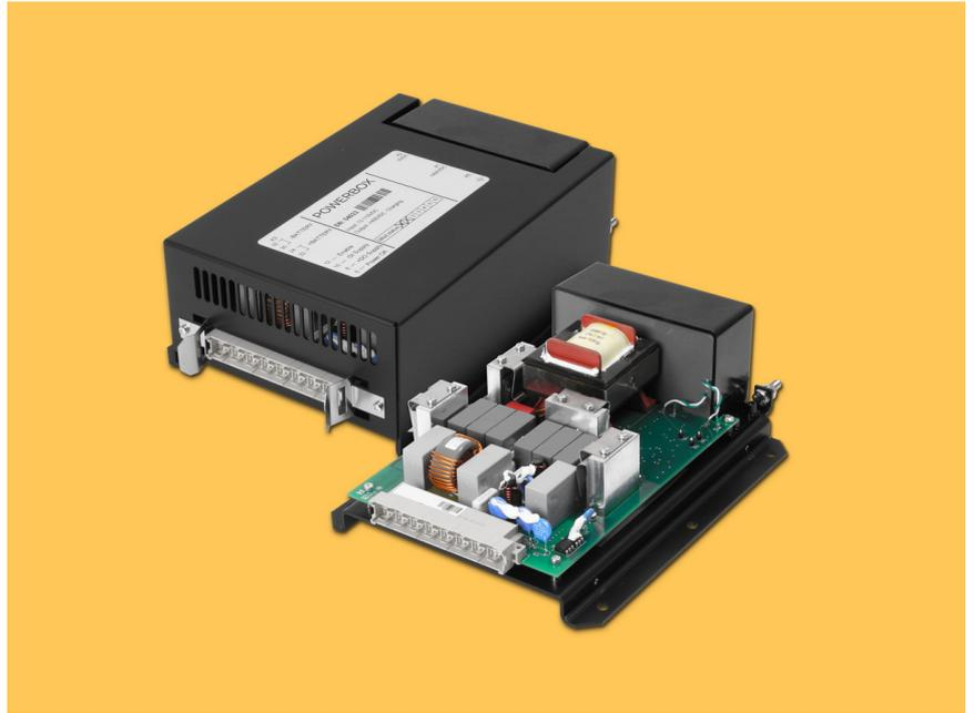
预充电电源将 50VDC 至 137.5VDC 的蓄电池标称母线电压转换为 400VDC 或 600VDC 的稳压输出电压，为控制电动阀门开关的电容组充电，比如开锁和升弓。
